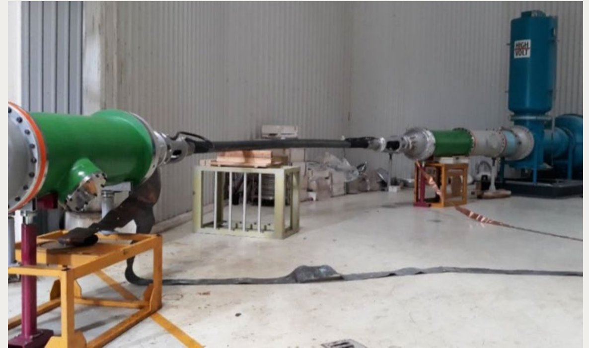
Рис.8 Обратная конфигурация подключения газа к кабелю 420 кВ при оценке диэлектрика
