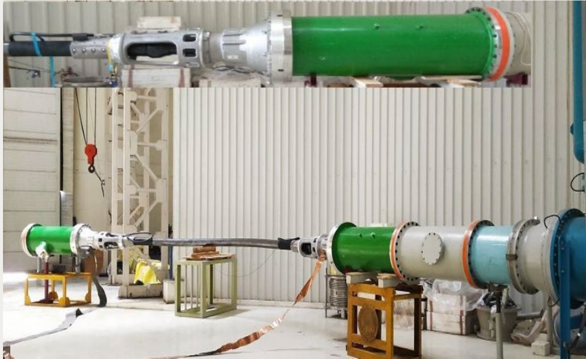
Рисунок 7: Конфигурация подключения газа в кабель встык для КРУЭ 420 кВ
