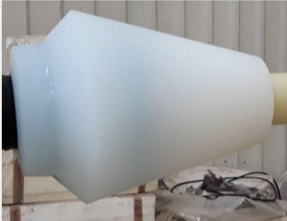
Рисунок 3: Конус напряжения силиконовой резины
